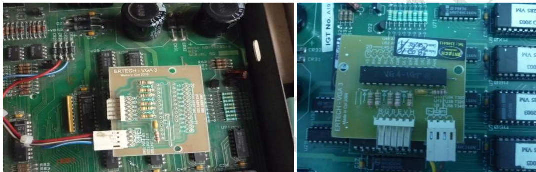
Tarjeta 340 con conector de 10 pines soldado a el integrado U45
